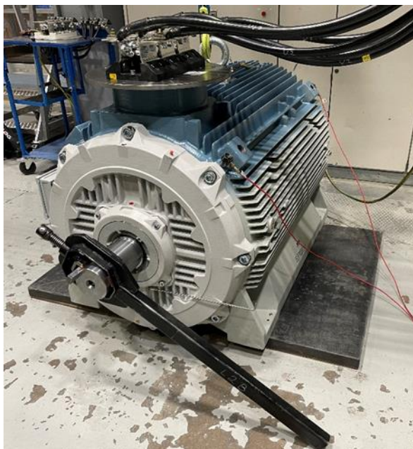
Kuva 1. Oikosulkumoottori akseli lukittuna.
