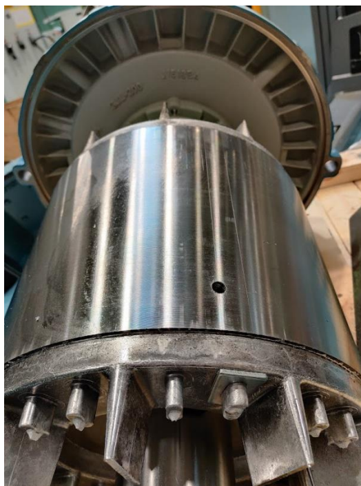
Kuva 23. 6-napaisen moottorin roottori, johon on porattu reikä.
