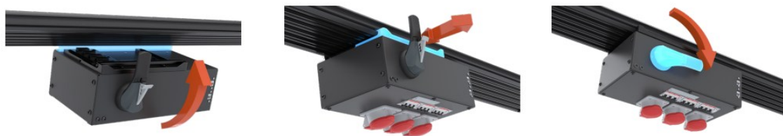
Kuva 34. Tap-off yksikön asentaminen jakelukiskoon (Vertiv PowerBar, s.3, 2025).
