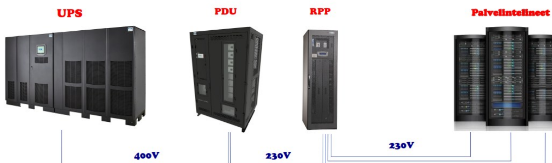
Kuva 13. Sähkönjakelu kaavio esimerkki UPS:ta palvelintelineille (mukaillen Testguy, 2022).
