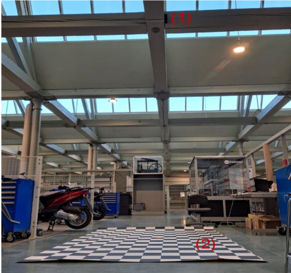
Kuva 11. Technobothnian laboratorion tilaan rakennettu tutkimusympäristö demonstraatiota varten, jossa ovat NC353L-kamera (1) ja mustavalkoinen ruudukkomatto (2).
