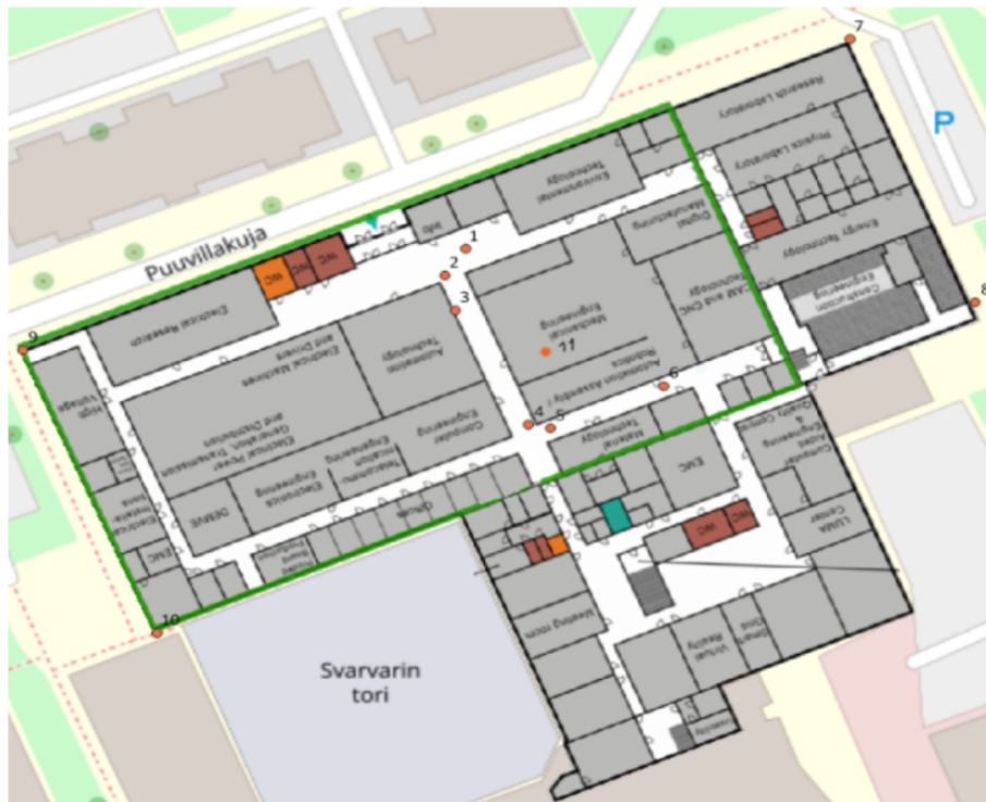
Kuva 7. Takymetrilla mitatut mittauspisteet merkittyinä Technobothnian karttaan. Georeferoitu Technobothnian pohjapiirustus (mukaillen Petri Välisuo, 2022).
