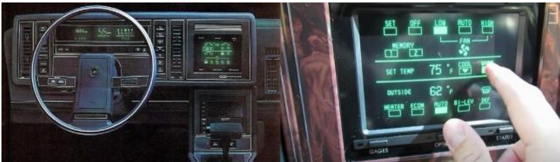
Kuva 1. 1986 Buick Rivieran kosketusnäyttö ja eri toimintoja keskikonsolin ruudulla (Dudziak & muut, 2024).
