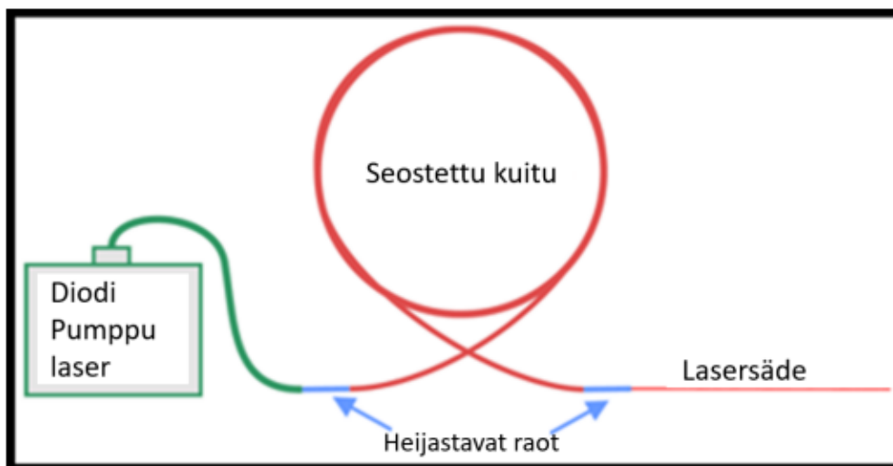
Kuva 8. Kuitulaserin toiminta pääpiirteittäin (mukaiillen Himeno, 2015, s. 26).
