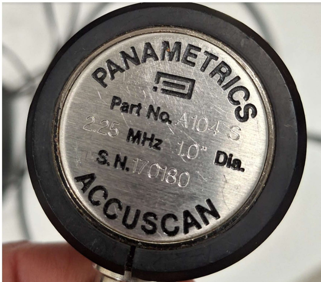
Kuva 14. Materiaalitestaukseen tarkoitettu ultraäänianturi.
