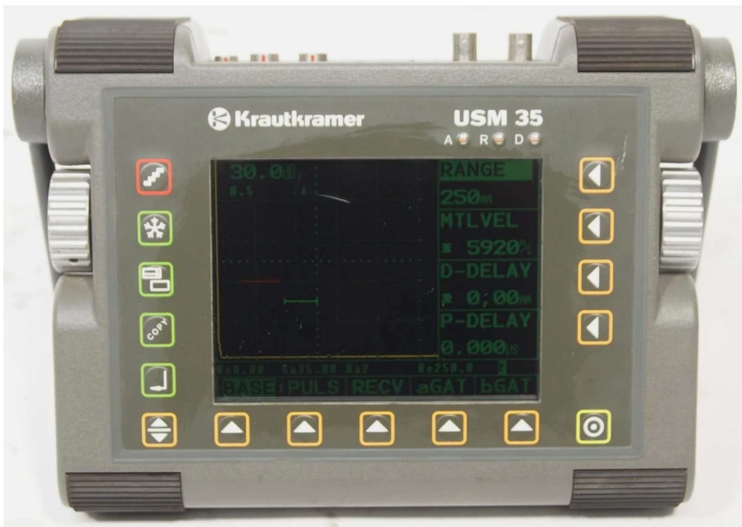
Kuva 13. Materiaalitestaukseen tarkoitettu ultraäänilaite. ( https://www.ebay.com/itm/326630950799 )
