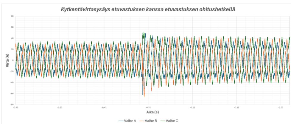
Kuva 10. Mitattu kytentävirtasysäys etuvastuksen kanssa ohitushetkellä.
