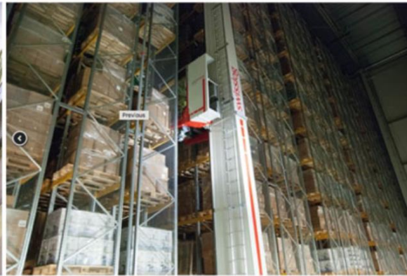
(d) Person-on-board AS/RS for pallet storage (Vanderlande Industries)
